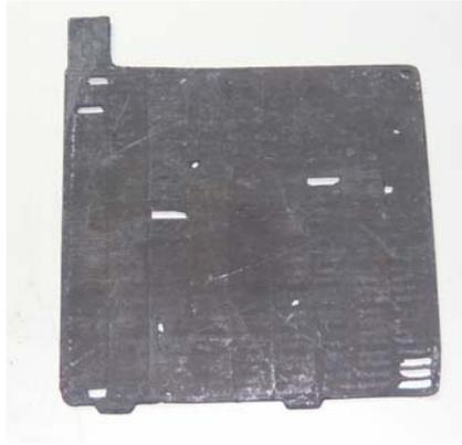
Fig.75- Placa de bateria de chumbo
