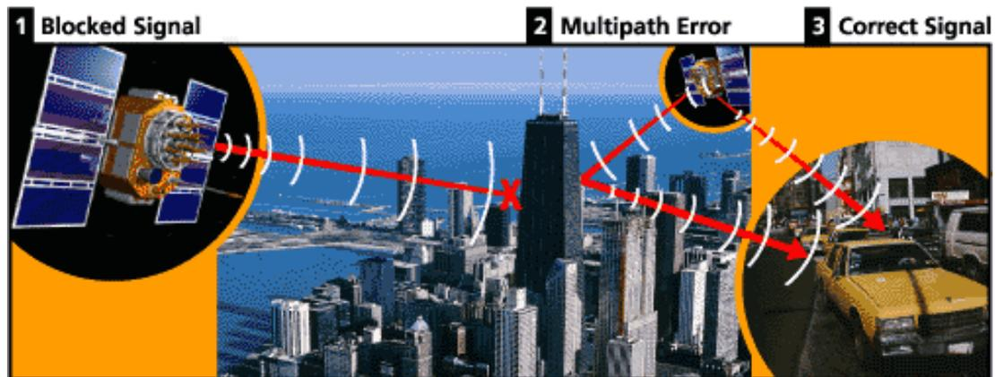
Fig.63- Emissão e recepção de GPS no dia-a-dia
