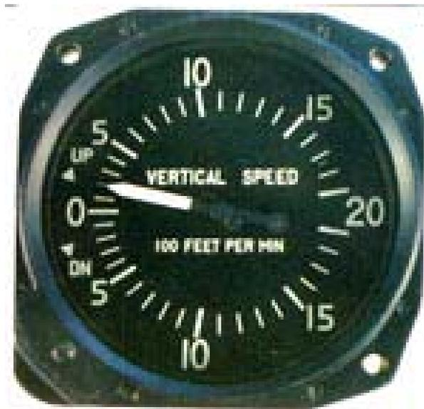
Fig.14- Variómetro (Indicador de Velocidade Vertical)
