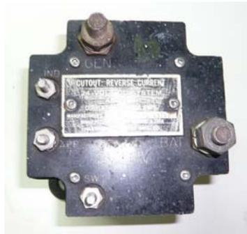
Fig.78 a)- Relé de corrente inversa
