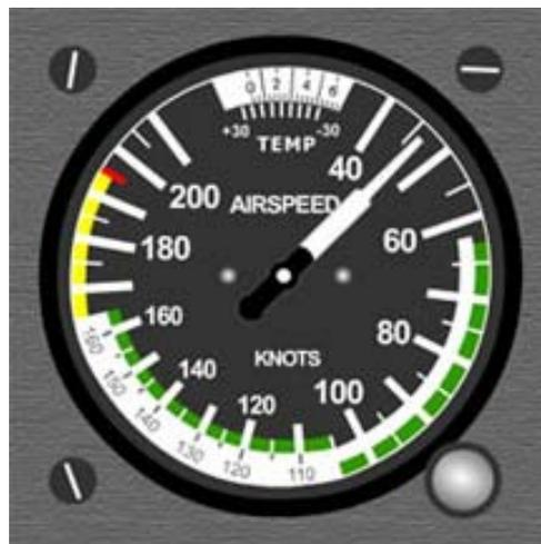
Fig.13- Indicador velocímetro
