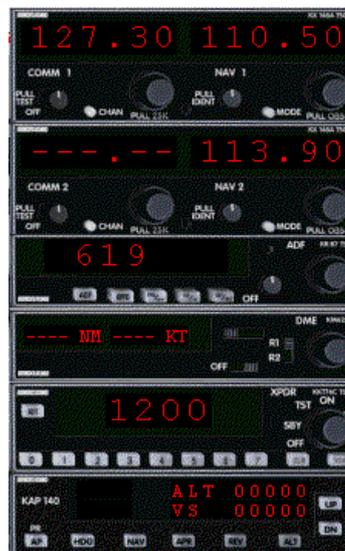
Fig.33- Painel de comando de comunicações de uma aeronave
