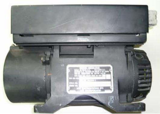
Fig.81- Inversor dinâmico
