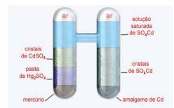
A f.e.m. de uma pilha Weston bem construída é 1,0183 volts a 20oC. Essa f.e.m. varia com a temperatura, mas existem fórmulas que permitem calcular a variação da f.e.m. em função da temperatura.
