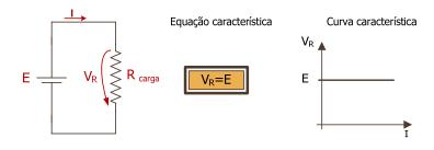
Porém, qualquer que seja a fonte de tensão (pilha, bateria de automóvel, fonte de tensão electrónica, etc...), ela apresenta sempre perdas internas, fazendo com que, para cargas muito baixas ou correntes muito altas, a sua tensão de saída  $V_R$  caia.
