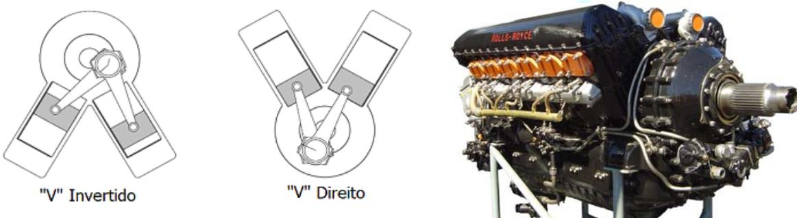
Figura 12 – Motor em V
