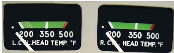
Figura 22 – Manómetros de temperatura dos cilindros
