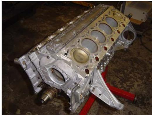
Figura 16 – Cárter de motores em V
