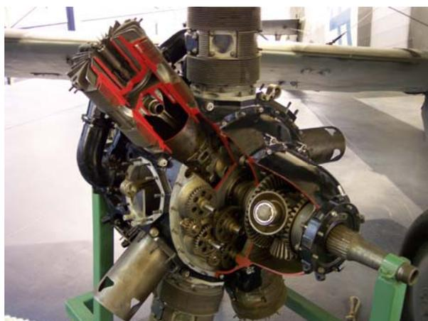
Figura 40 – Caixa redutora do motor
