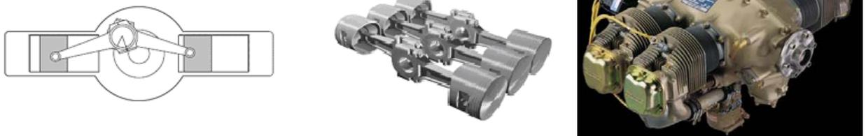
Figura 13 – Motor de cilindros opostos
