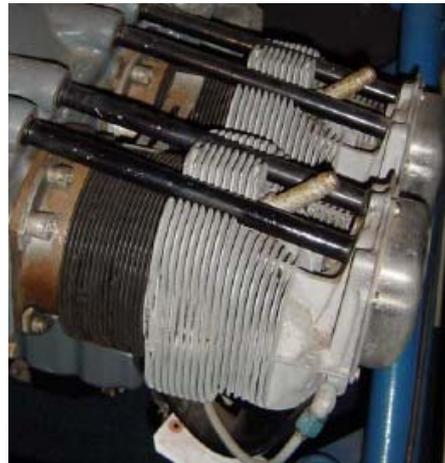
**Figura 18 – Cilindros de um motor de avião arrefecido por ar**
