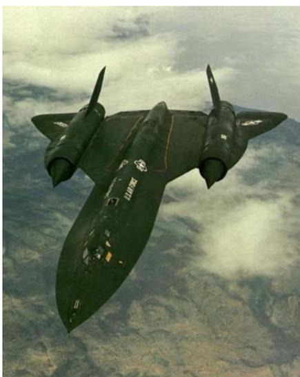
Figura 38 – Avião SR-71 pioneiro no uso operacional de estato-reactores
