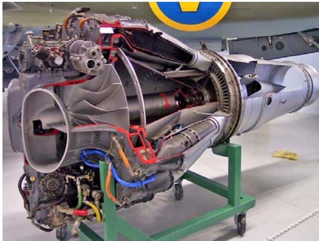
**Figura 8 – Motor turbo-jacto Goblin descendente directo do motor W2-700**
