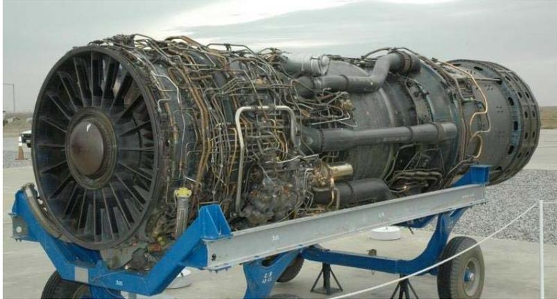
Figura 39 – Motor turbo-estato Pratt & Whitney J58 que equipava o SR-71
