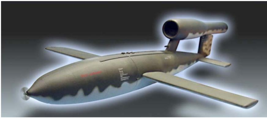
Figura 35 – Bomba voadora V-1 equipada com o motor pulso-jacto Argus As 014
