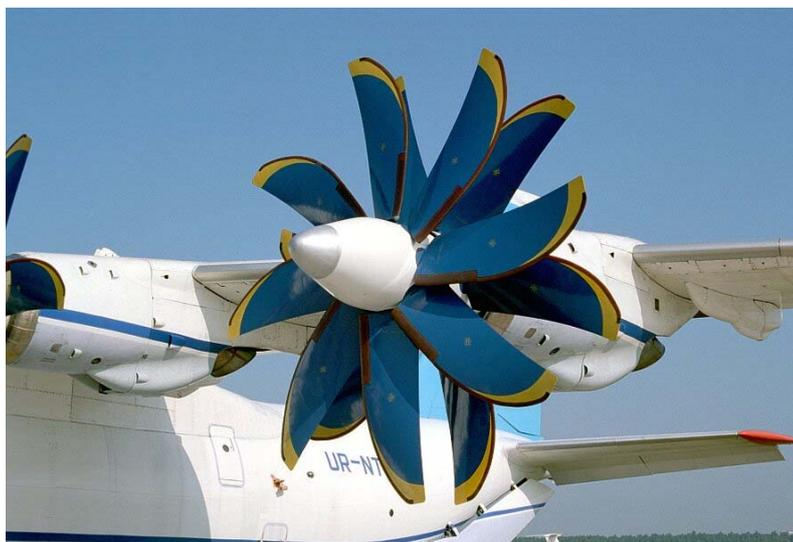
Figura 28 – Propfan *Progress D-27* de configuração tractora utilizada no Antonov An-70
