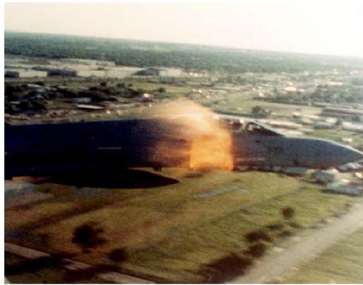
Figura 62 – Inversão do fluxo de ar causada pelo fenómeno de *surge*
