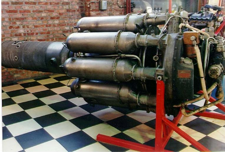
**Figura 5 – Primeiro motor operacional produzido pela equipa de Whittle o W2-700**
