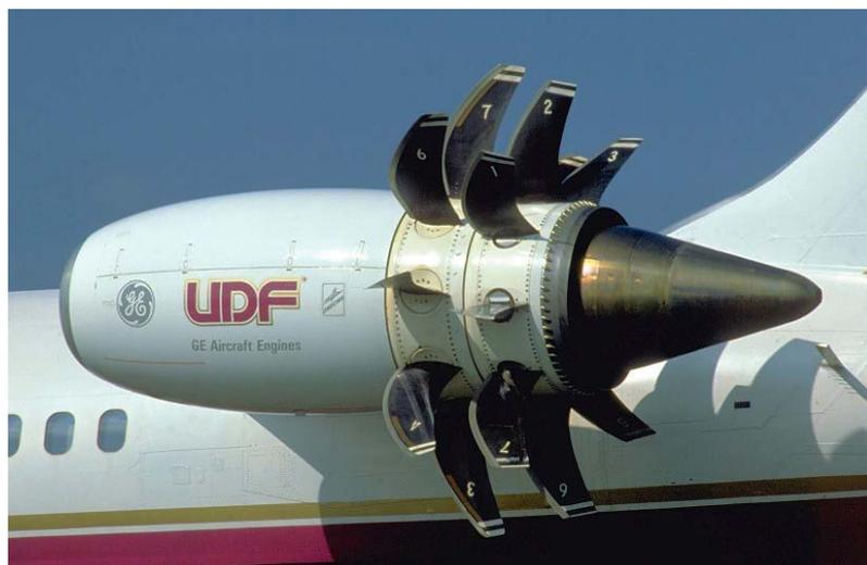
Figura 27 – Propfan impulsora desenvolvida pela General Electric
