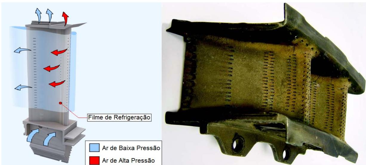
Figura 86 – Pormenor dos pontos de saída do ar de refrigeração
