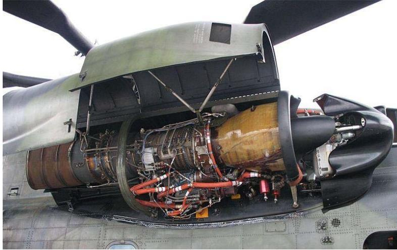
Figura 30 – Motor turbo-eixo de um helicóptero
