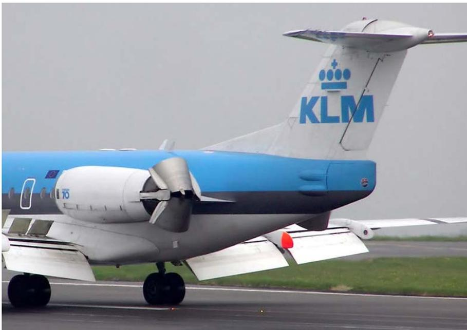
Figura 94 – Sistema de reversão de impulso em funcionamento
