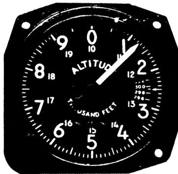
Altímetro não sensitivo
